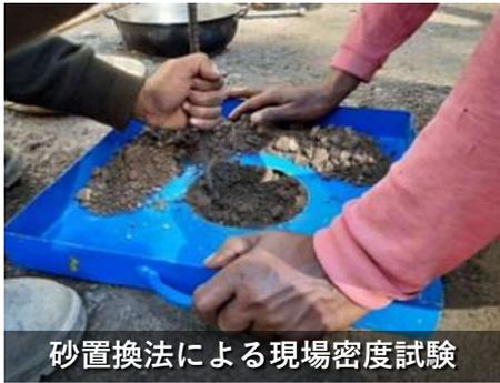
砂置換法による現場密度試験
