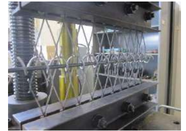
写真-2 引張試験(連結材あり)
